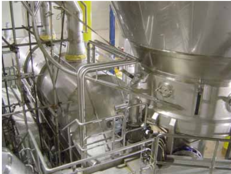
Fluid bed med ett Simatek filter i rostfritt stål
