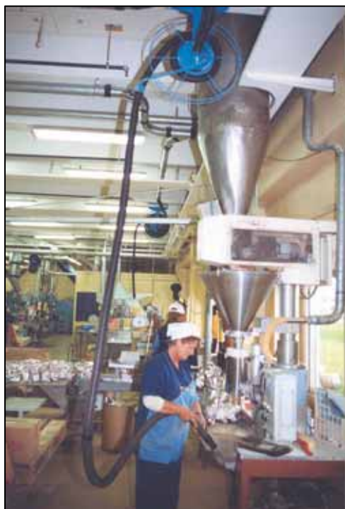
Центральное вакуумное устройство, Дания
