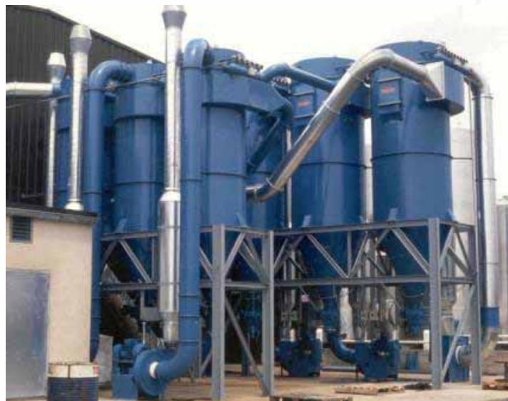
SimPact 4T Puls-Jet Filter filtrieren Marmor-, Glas- und Polyesterstaub bei S.T.D. in Frankreich
