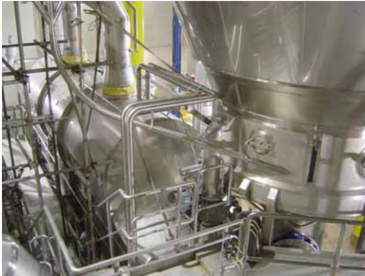
Fluid bed med Simatek filter i rustfrit stål
